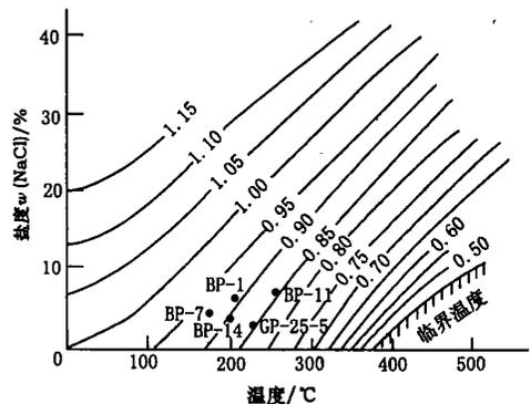
图 3 NaCl-H<sub>2</sub>O 体系的温度-盐度-密度关系图
