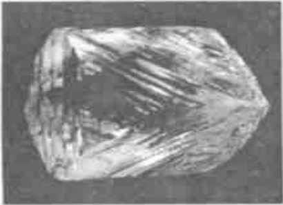
图 3 钻石八面体晶体四组解理(据《矿物珍品》) Fig. 3 4 groupes of cleavages of in octahedron diamond crystal
